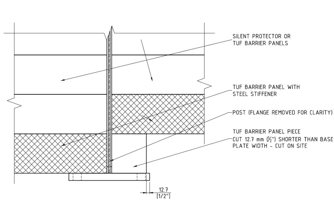
**TYPICAL STEPPED DETAIL - TYPICAL FOR GROUND MOUNTED POSTS**
