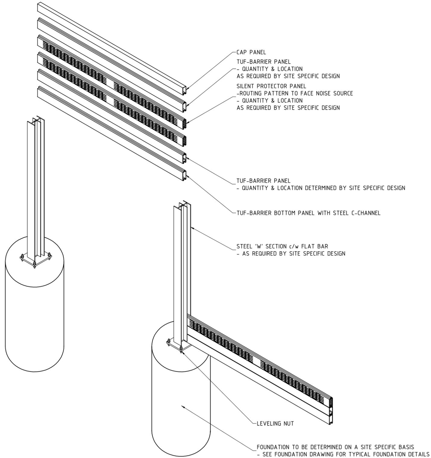
TYPICAL ASSEMBLY ISOMETRIC DETAIL
