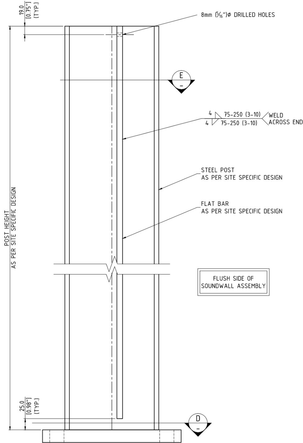
TYPICAL GROUND MOUNTED STEEL POST DETAIL - SIDE VIEW
